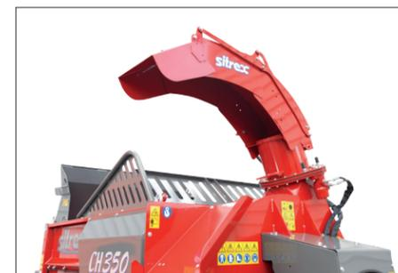
Scarico orientabile fino a 300° di rotazione, e con la possibilità di installare il kit pompa per spruzzare l'acqua sullo scarico in modo da ridurre la polvere durante la fase di lancio del prodotto sulle lettiere. / Unloader direction adjustable up to 300° of rotation, and with the possibility of installing the pump kit to spray water on the discharge so as to reduce dust when throwing the product on bedding.
