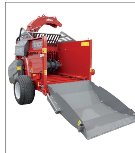
Porta di carico di grandi dimensioni per poter caricare fino a due rotoballe di Ø 1800 mm oppure n°1 balla quadra / Large loading door allows loading up to two round bales diam. 1800mm or one square bale.
