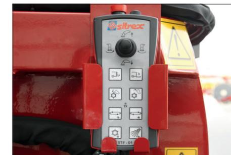
Pulsantiera per i comandi elettrici semplice e funzionale con joystick per l'orientamento dello scarico e potenziometro per la regolazione della velocità del nastro trasportatore / Simple, functional electric control panel with joystick for adjusting the unloading direction and potentiometer for regulating the conveyor belt speed.
