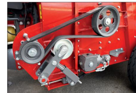
Trasmissione al rotore tramite una cinghia a n°4 gole molto resistente, e con ammortizzatore salva strappi a molla / Rotor driven by a very strong 4-groove belt, and with spring belt tensioner.
